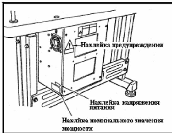
Спецификации напряжения питания указаны на наклейке напряжения питания (только для двигателей с трехфазным напряжением). Для других типов машин, спецификации напряжения питания указаны на наклейке предупреждения о напряжении питания и наклейке номинального значения мощности. Подсоедините кабель питания в соответствии со спецификациями.
